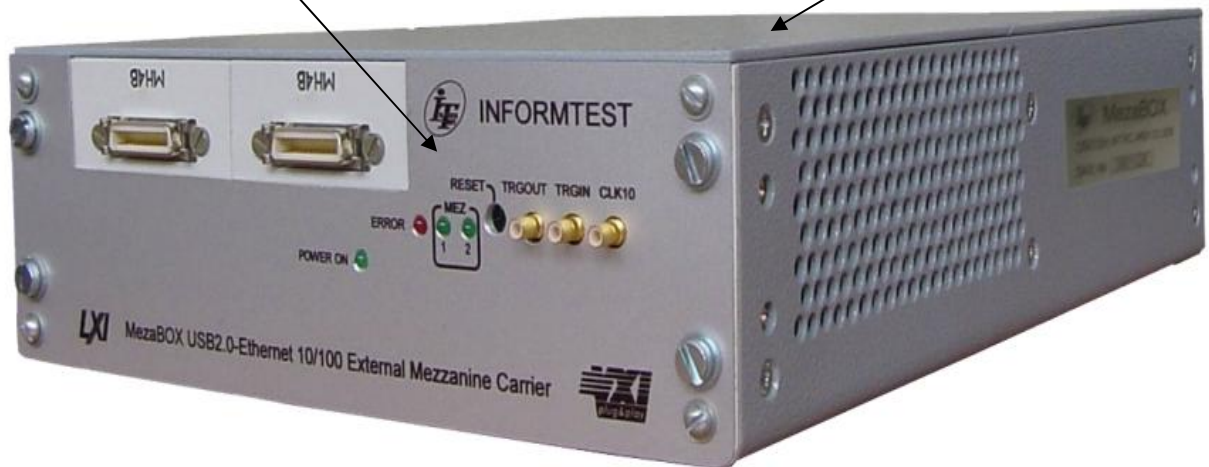
Рисунок 1 – Внешний вид устройства MezaBox с установленными измерителями, указанием места нанесения знака утверждения типа и местом пломбировки
