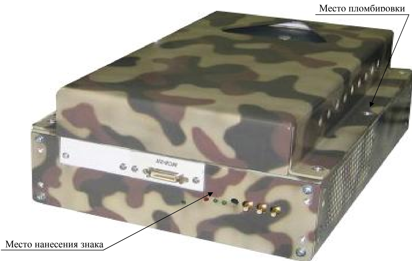
Рисунок 2 – Внешний вид устройства MezaBox\Battery 133W-hrs с установленным измерителем, указанием места нанесения знака утверждения типа и местом пломбировки
