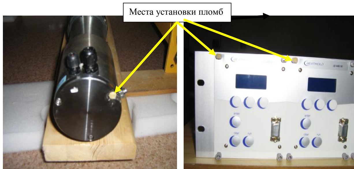
Рисунок 2 – Установка пломб на блоках радиоизотопных измерителей уровня LB440.
