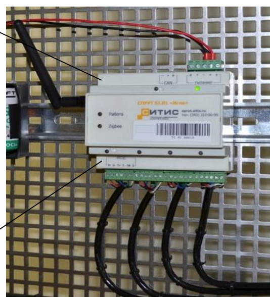
1 – первичный преобразователь (тензометр), 2 - регистратор Рисунок 1 - Внешний вид комплекса измерительного СПРУТ 2.01.01.
