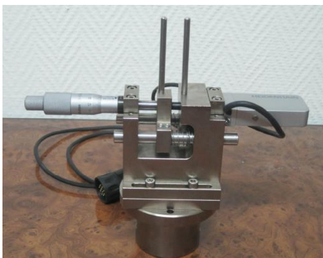
Рис.3. Приспособление для закрепления измерительных щупов СТ 6002 и МТ 60 К на траверсе испытательной машины.
