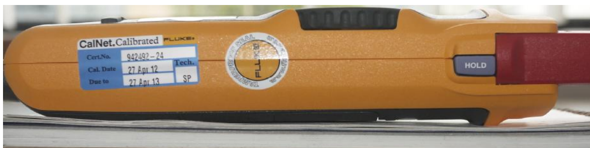
Рисунок 3 - Место пломбирования от несанкционированного доступа
