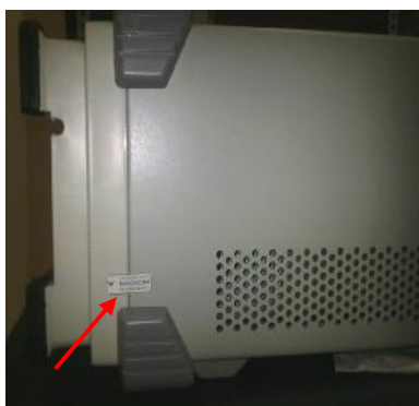
Рисунок 2а - Место для пломбировки от несанкционированного доступа
