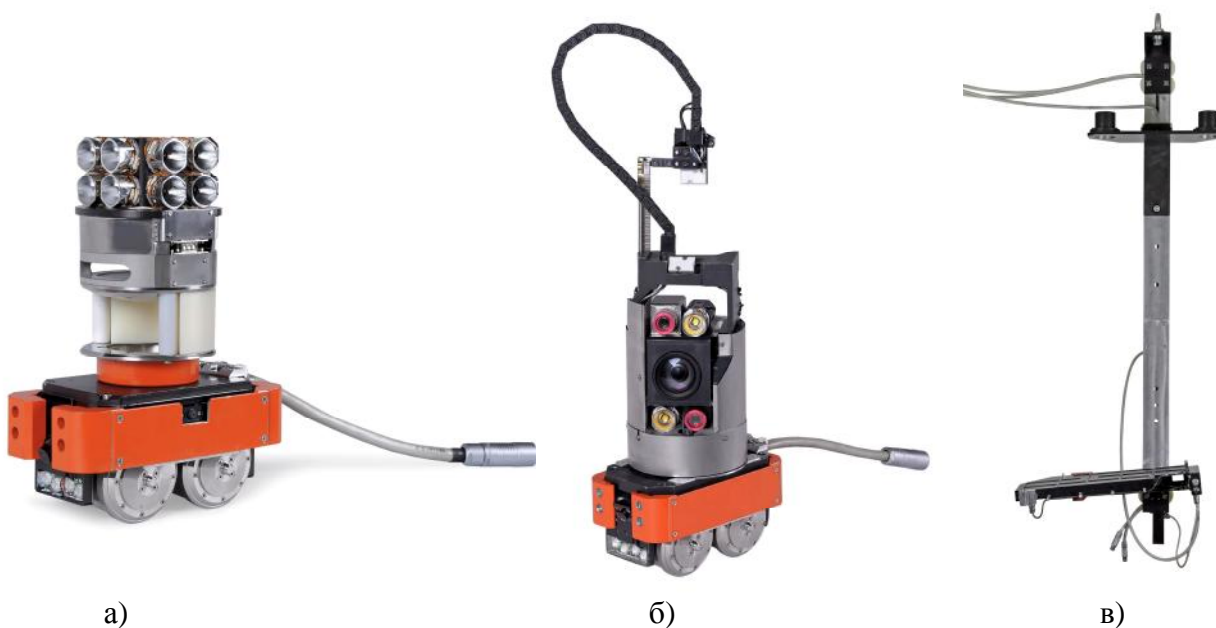
Рисунок 1 - Внешний вид системы диагностической СК-Э а) робот поддержки, б) робот-контролер, в) загрузочное устройство
