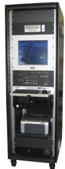
Стойка управления с весовым терминалом
