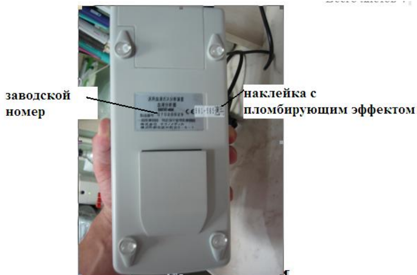
Рисунок 2 – Схема пломбировки и маркировки
