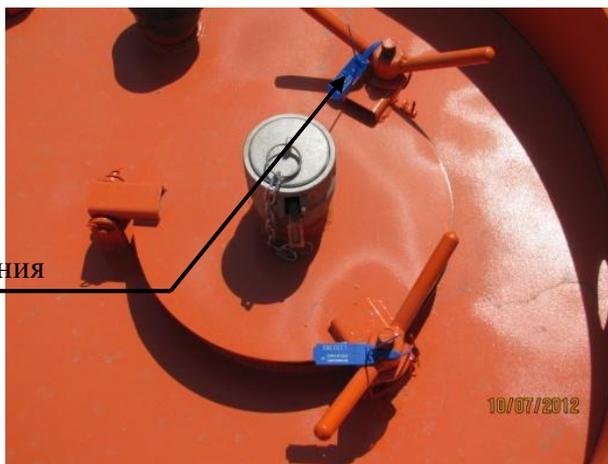
Рисунок 3 – Запорный механизм крышки заливной горловины АЦ
