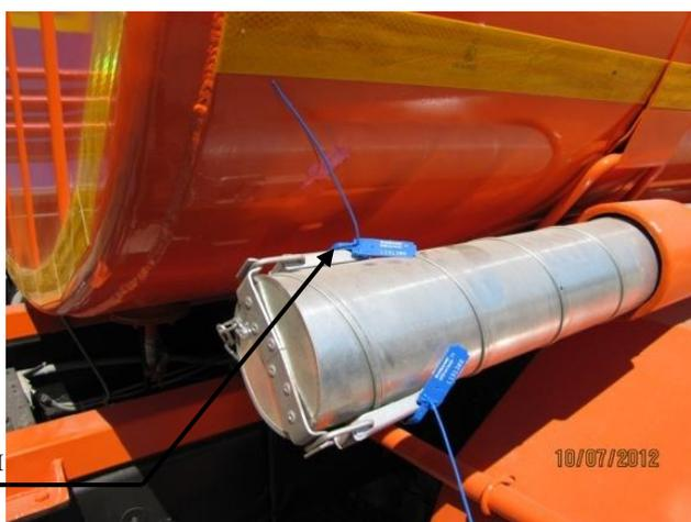
Рисунок 5 – Пеналы размещения раздаточных рукавов АЦ
