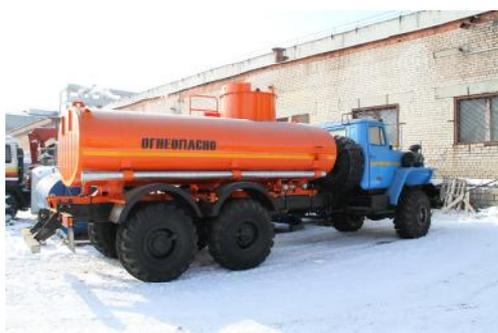
Рисунок 1 – АЦ с одним отсеком
