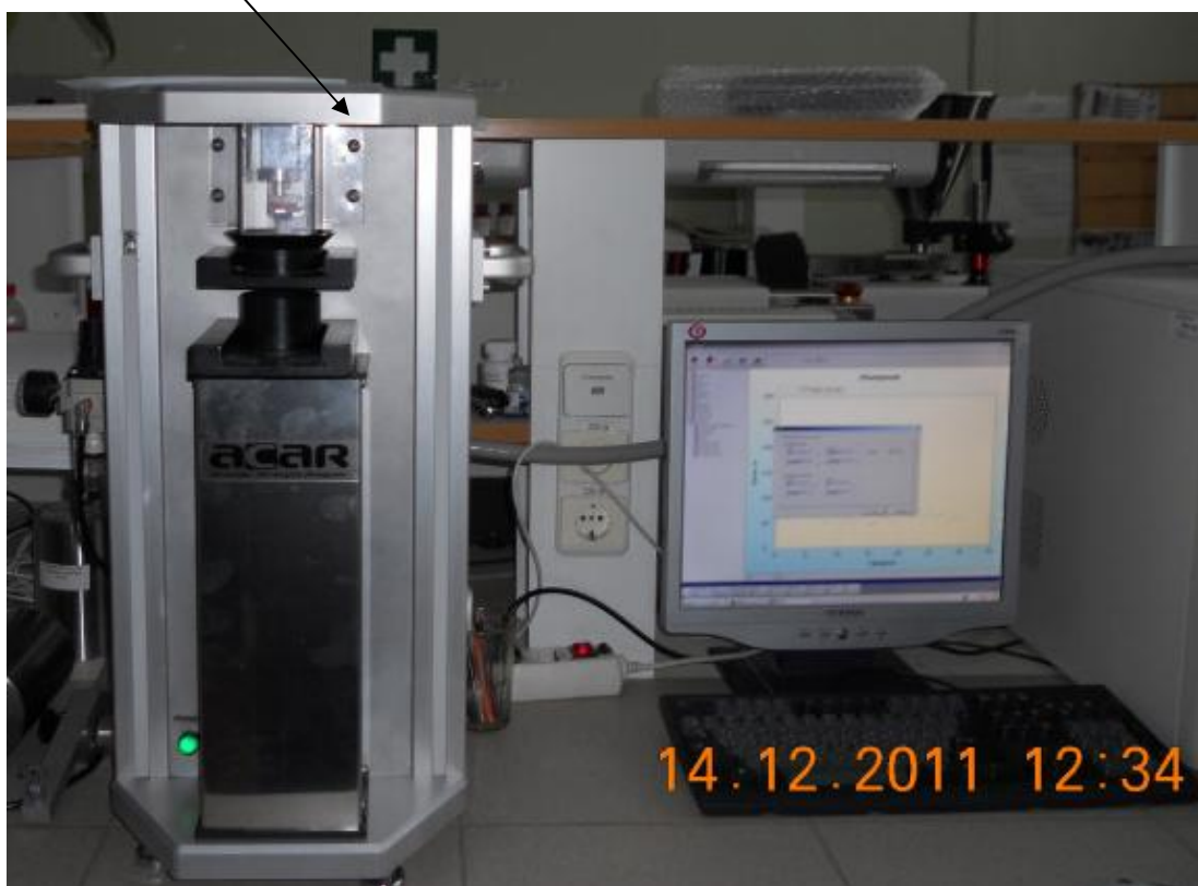
Рисунок 1 – Фото общего вида анализатора статической прочности гранул ACAR
