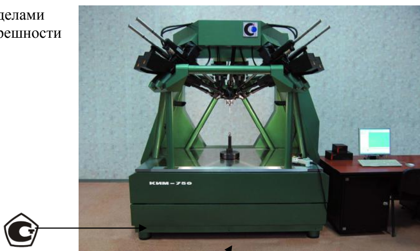
Рисунок 1 - Внешний вид координатных измерительных машин КИМ 750 и место нанесения знака утверждения типа
