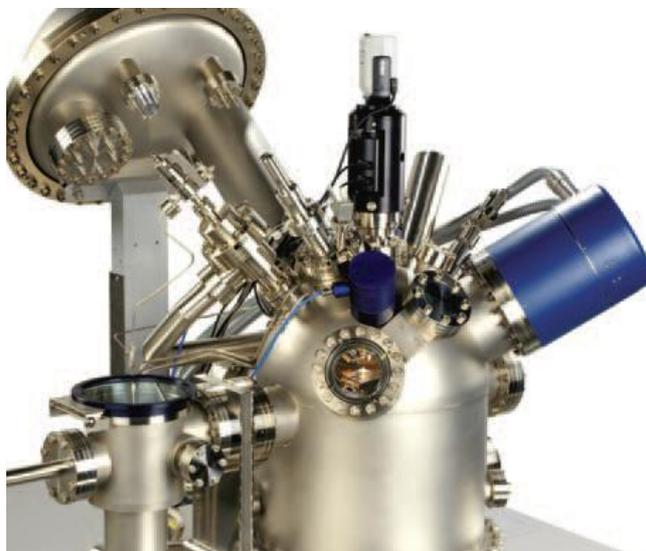
Рисунок 1. Общий вид спектрометров рентгеновских фотоэлектронных многофункциональных Theta Probe.
