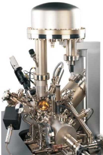
Рисунок 1. Общий вид многофункционального рентгеновского фотоэлектронного спектрометра Escalab 250Xi.
