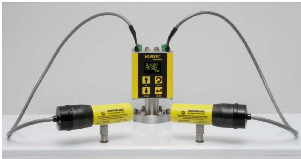
Рисунок 1 – Общий вид вакуумметра широкодиапазонного IGM402
