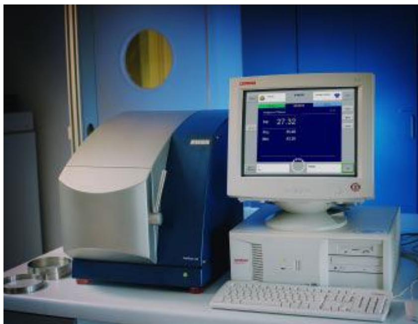
Рисунок 1 Внешний вид анализаторов FoodScan Lab
