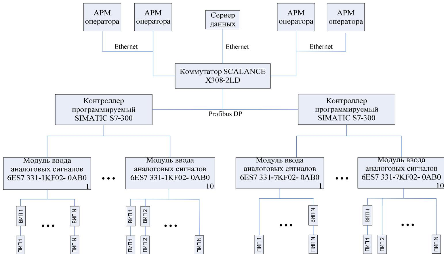
ПИП – первичный измерительный преобразователь, ВИП – вторичный измерительный преобразователь
