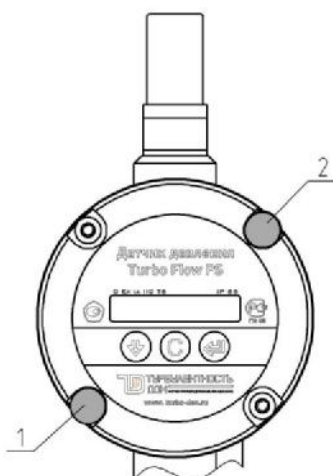
Рисунок 2 - Схема пломбирования датчика давления Turbo Flow PS.
