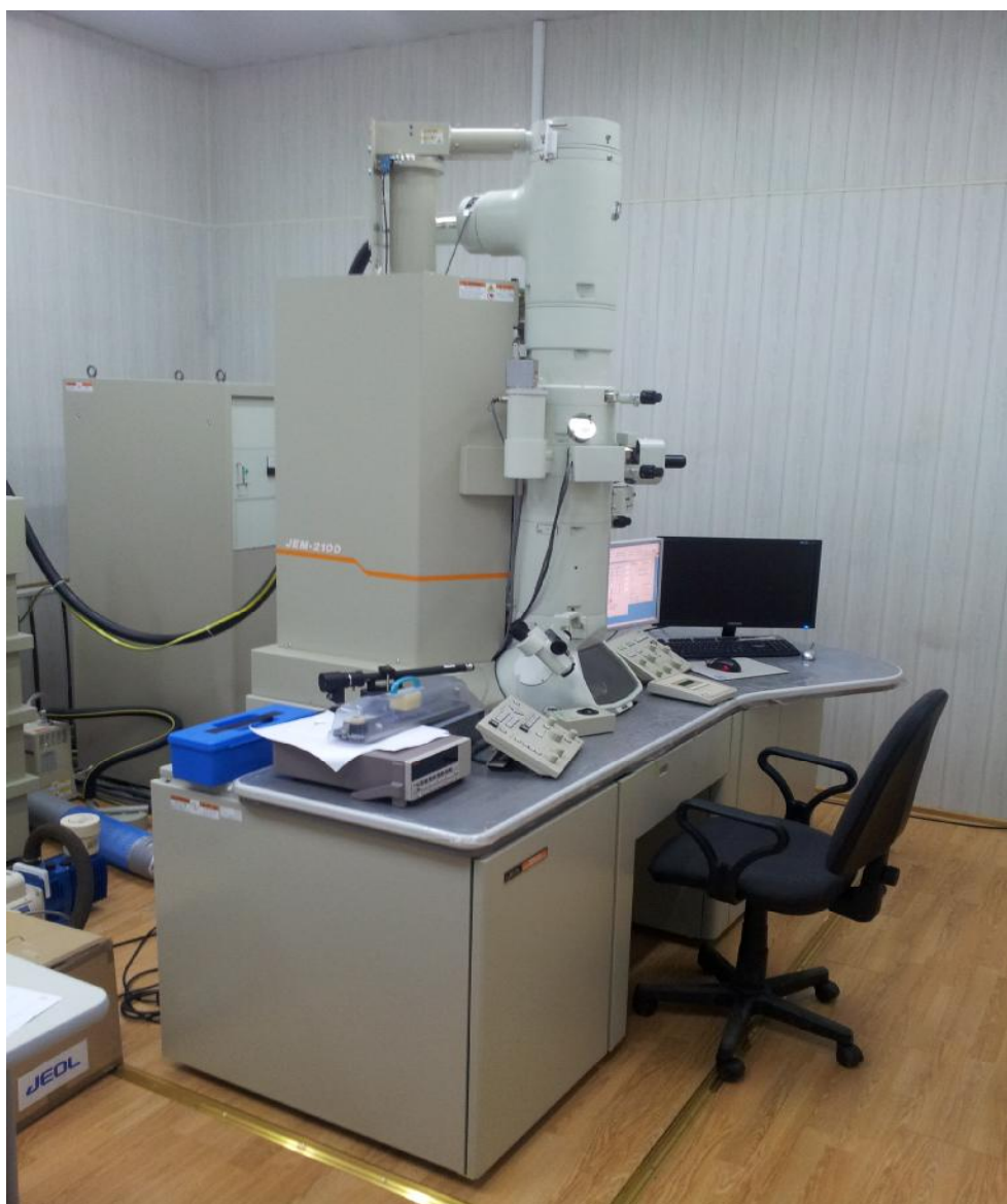
Рис.1. Общий вид микроскопа электронного просвечивающего JEM-2100
