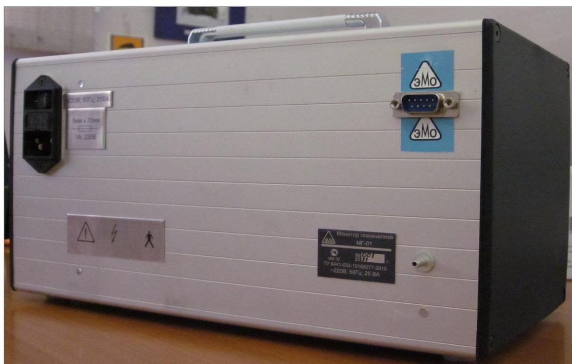
Рисунок 2 – Задняя панель монитора газоанализа МГ-01, внешний вид.
