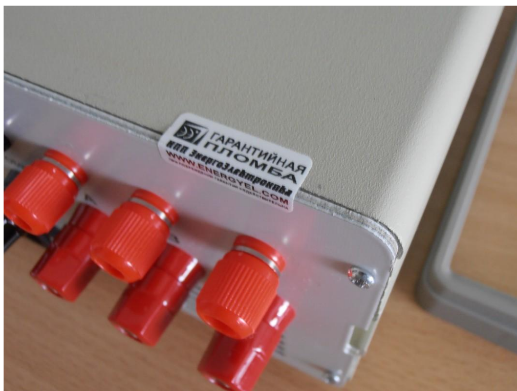
Рисунок 2. Место пломбирования установки МИКРОН.
