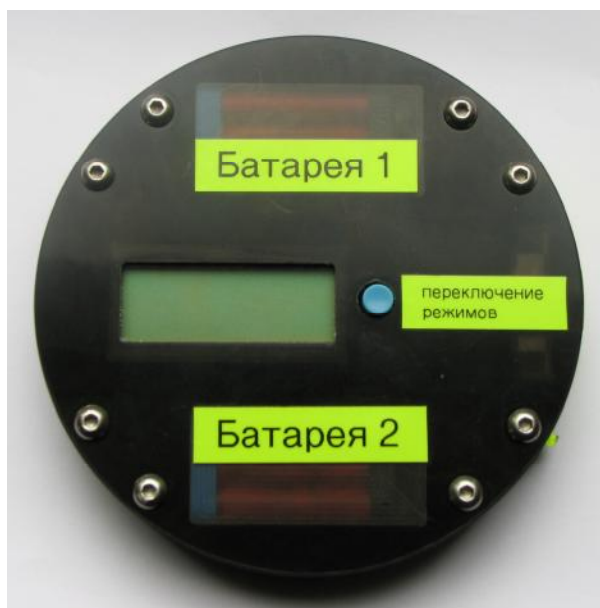
Рисунок 1. Общий вид акселерометра персонального специалиста по лифтам PALS
