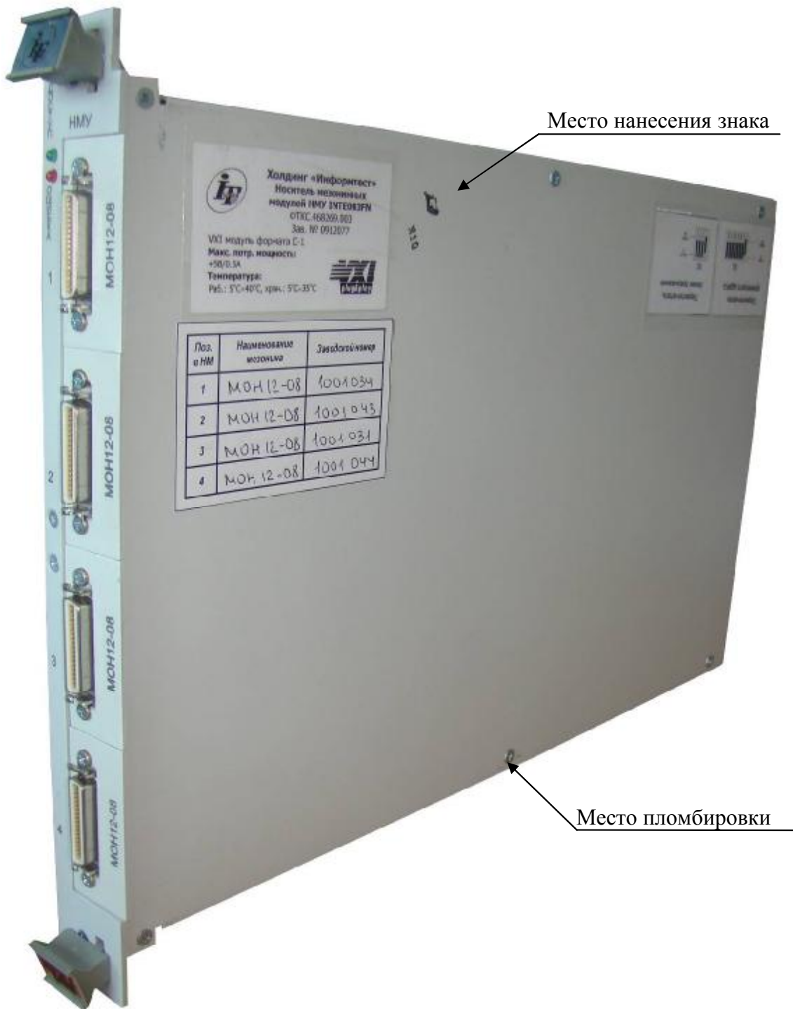
Рисунок 3 – Внешний вид носителя мезонинных модулей типа НМ-С (НМ, НМУ) с установленными источниками напряжения постоянного тока, указанием места нанесения знака утверждения типа и местом пломбировки
