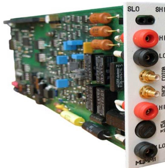
Рисунок 4 – Внешний вид мультиметра цифрового МЦММ1 UNC3.031.145
