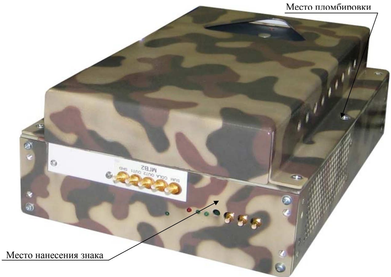
Рисунок 2 – Внешний вид устройства MezaBox\Battery 133W-hrs с установленным генератором сигналов, указанием места нанесения знака утверждения типа и местом пломбировки
