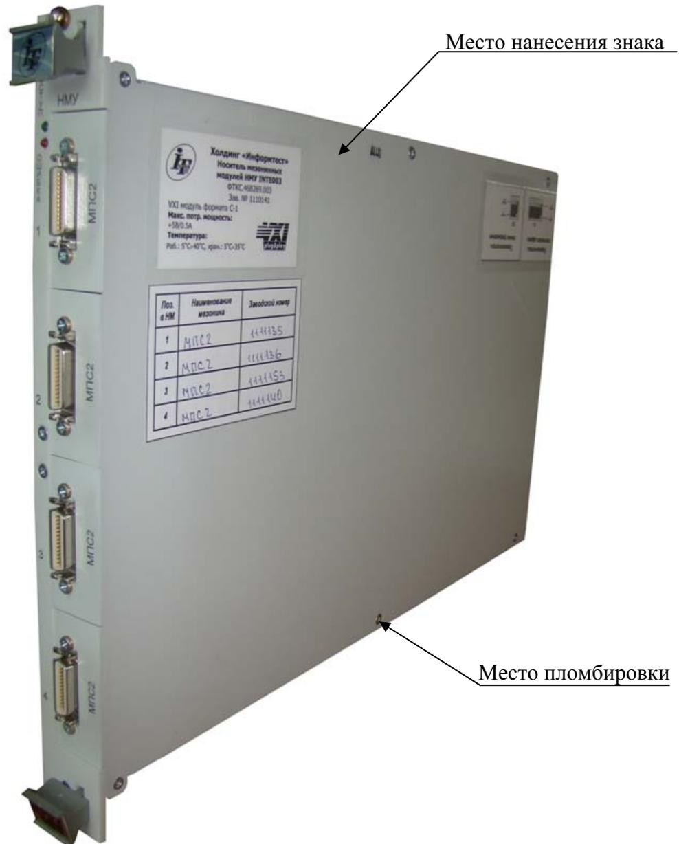
Рисунок 3 – Внешний вид носителя мезонинных модулей типа НМ (НМ-С, НМУ) с установленными электронными магазинами, указанием места нанесения знака утверждения типа и местом пломбировки
