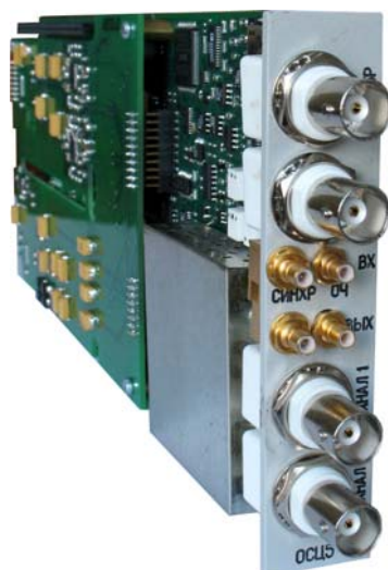
Рисунок 4 – Внешний вид осциллографа цифрового OCЦ5 UNC3.031.150
