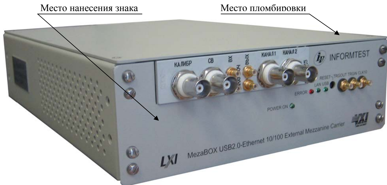
Рисунок 1 – Внешний вид устройства MezaBox с установленным осциллографом цифровым, указанием места нанесения знака утверждения типа и местом пломбировки
