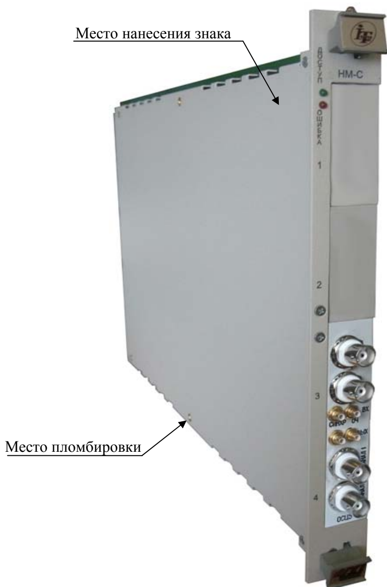
Рисунок 3 – Внешний вид носителя мезонинных модулей типа НМ (НМ-С, НМУ) с установленным осциллографом цифровым, указанием места нанесения знака утверждения типа и местом пломбировки
