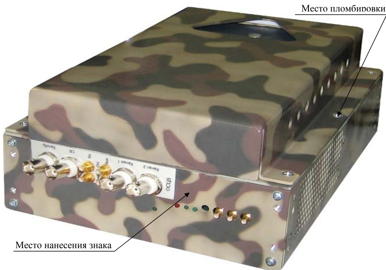
Рисунок 2 – Внешний вид устройства MezaBox\Battery 133W-hrs с установленным осциллографом цифровым, указанием места нанесения знака утверждения типа и местом пломбировки
