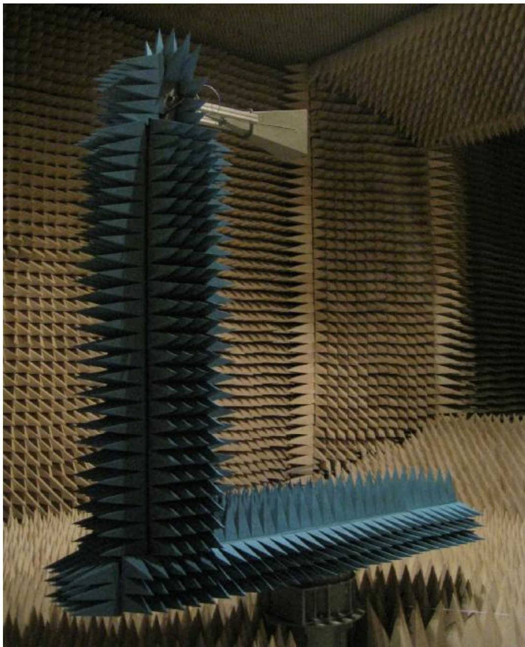
Рисунок 1 - Внешний вид ОПУ с установленной антенной П6-23М
