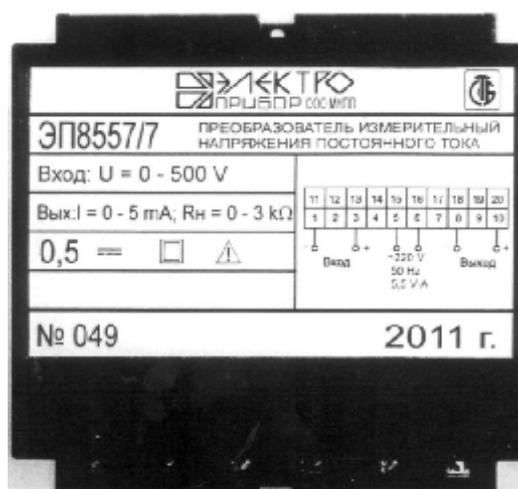
Рисунок 1 – Внешний вид преобразователя измерительного напряжения постоянного тока ЭП8557
