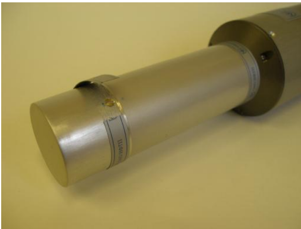
Рисунок 2 – Защита спектрометра – дозиметра энергий гамма-излучения полупроводникового СЕГ-ЗКП от несанкционированного доступа
