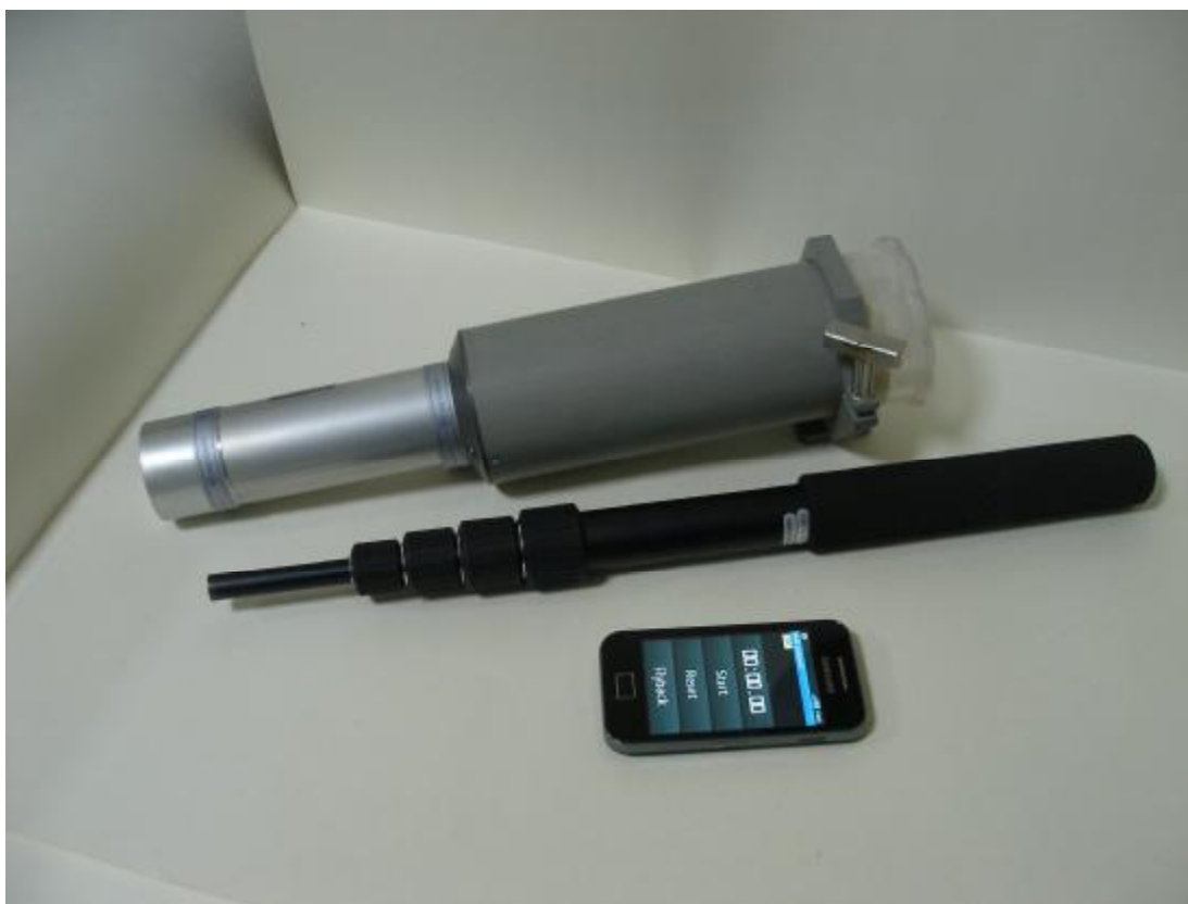
Рисунок 1 – Общий вид спектрометра – дозиметра энергий гамма-излучения полупроводникового СЕГ-ЗКП.
