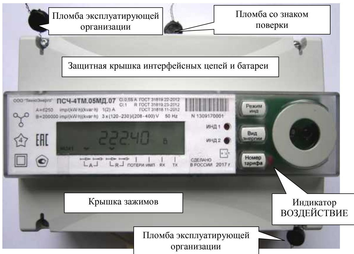
Рисунок 1 - Общий вид счетчика с закрытыми крышками, схема пломбирования от несанкционированного доступа, обозначение места нанесения знака поверки
