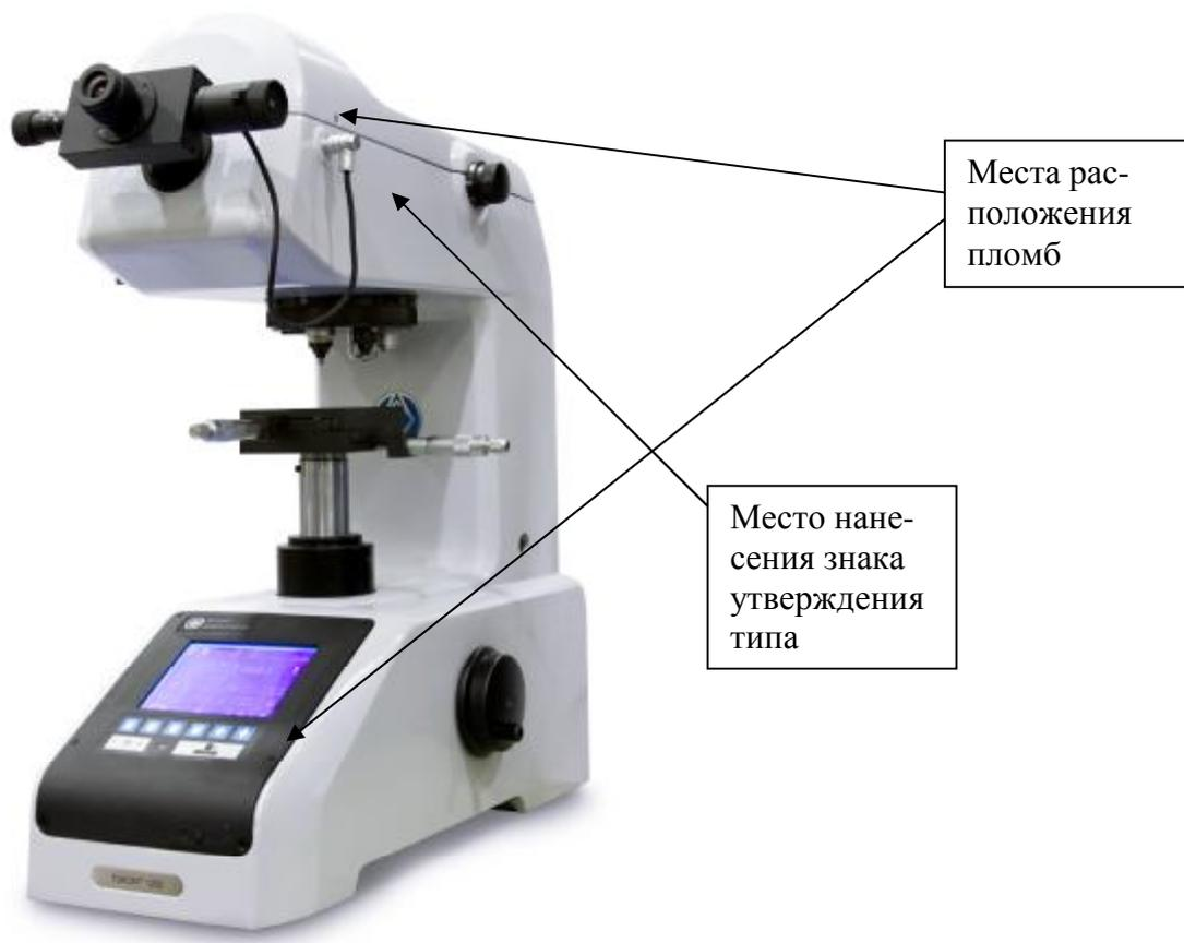
Рисунок 2 – Места расположения пломб и место нанесения знака утверждения типа.
