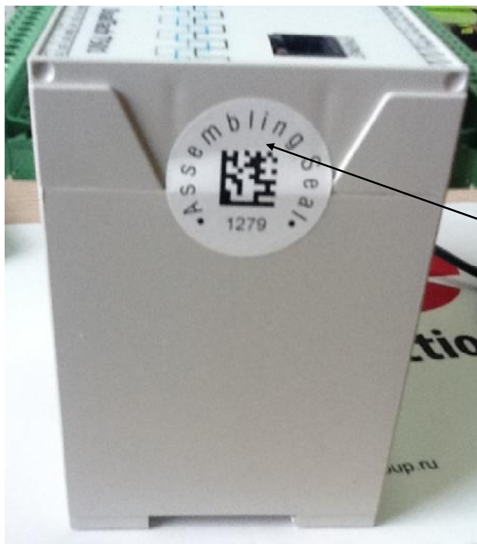
** - Место пломбировки от несанкционированного доступа Рисунок 2
