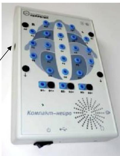
Место пломбировки от несанкционированного доступа.
