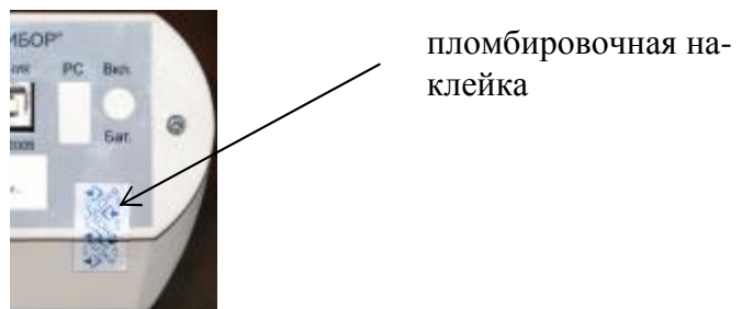
Рисунок 3 – Схема пломбирования солемеров
