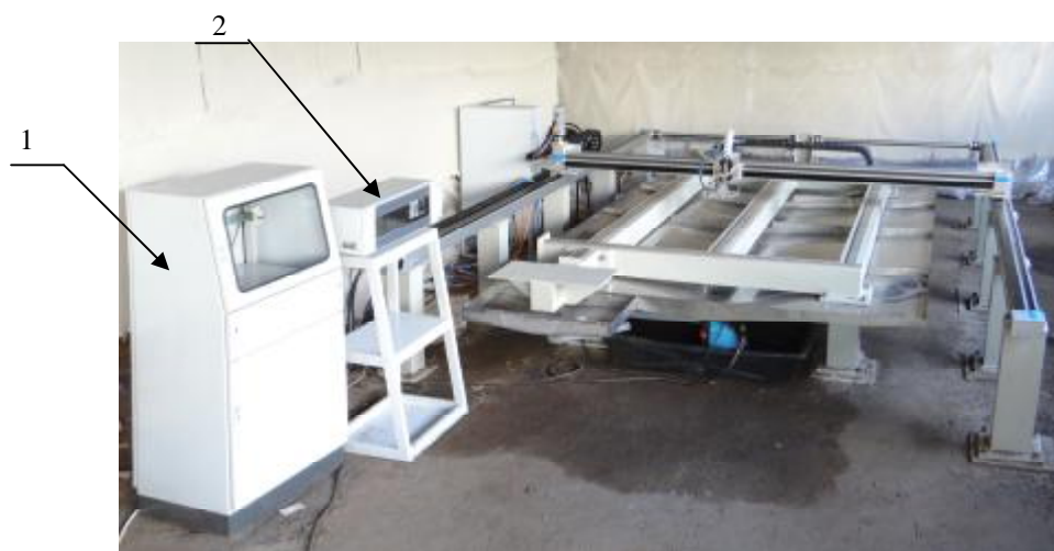
1 - вычислительный комплекс (шкаф, компьютер, принтер, источник бесперебойного питания); 2 - восьмиканальный дефектоскоп;
