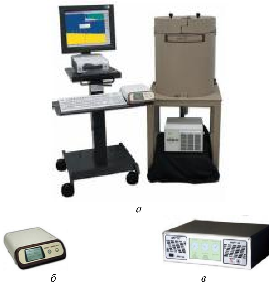
а – общий вид спектрометра б – анализаторы DSPec jr 2.0, DSPec Pro, DSPec LF в – анализаторы DSPec 50, DSPec 502
