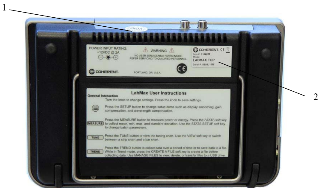
Рисунок 2 – Схема маркировки блока регистрации ваттметра (вид снизу)
