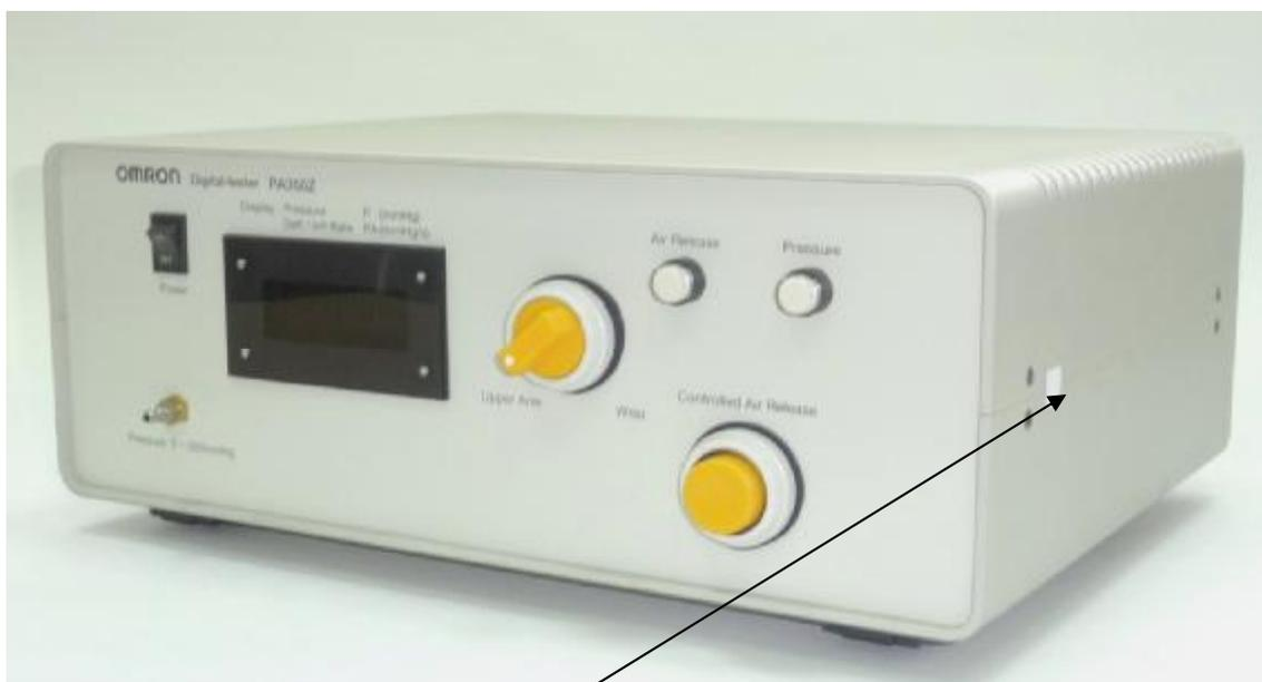
Место нанесения защитной наклейки от несанкционированного доступа.
