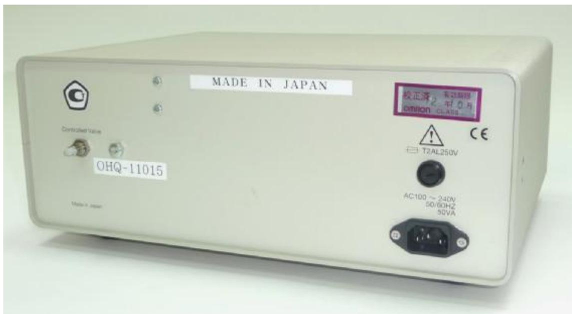
Рисунок 2 – Измеритель давления цифровой тестовый OMRON PA350Z. Задняя панель.
