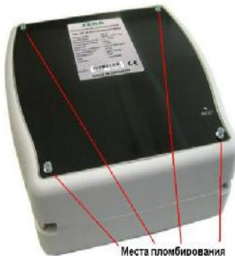
Рисунок 2. Задняя панель
