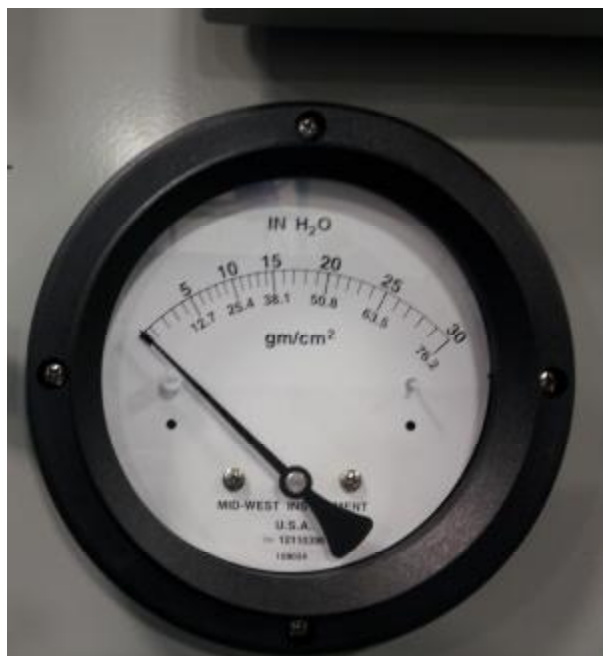
Рисунок 1. Манометр дифференциальный модель 130.
