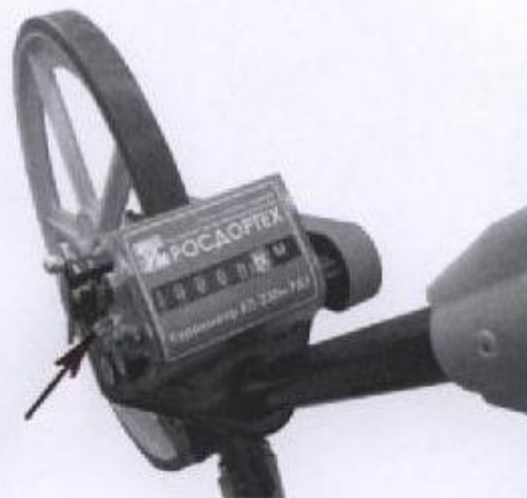
Рисунок 3 – Место установки пломбы изготовителя на модели КП-230м РДТ
