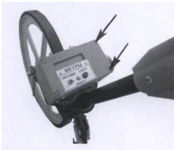
Рисунок 2 – Места установки пломб изготовителя на модели КП-230 РДТ
