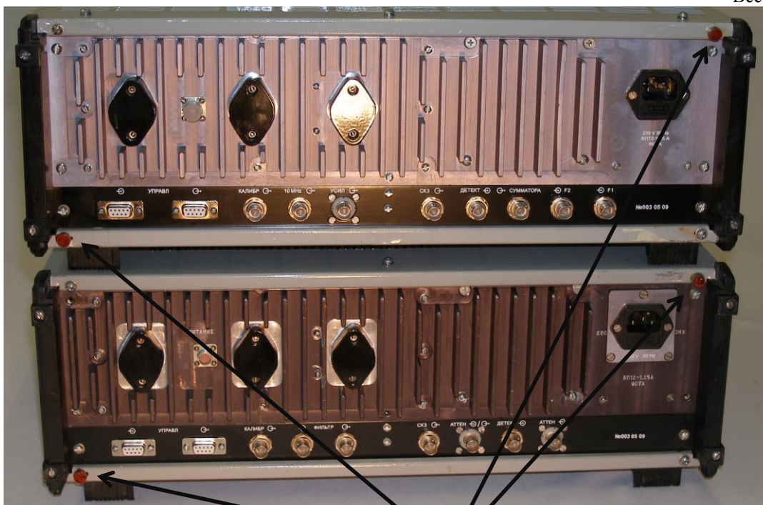
Стрелками указаны места установки пломб.
