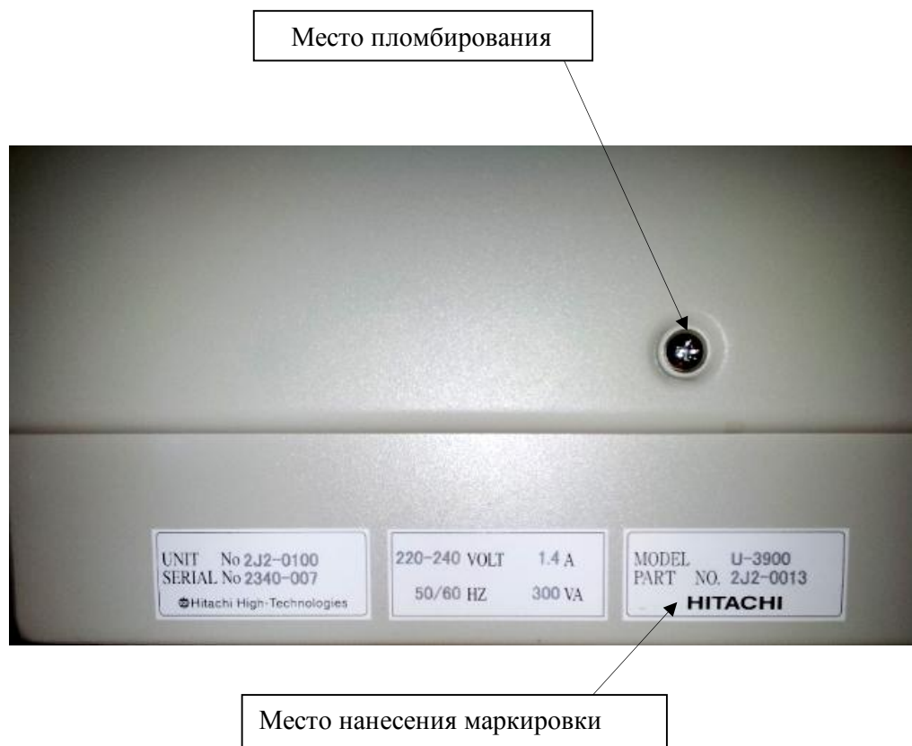
Рисунок 2 - Место нанесения маркировки и место пломбирования спектрофотометров U-3900, U-3900H
