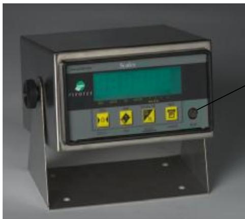
Поверительное клеймо ставится на пломбу, установленную на винт безопасности, расположенный на передней панели Scalex 1700 и скрывающий кнопку настройки
