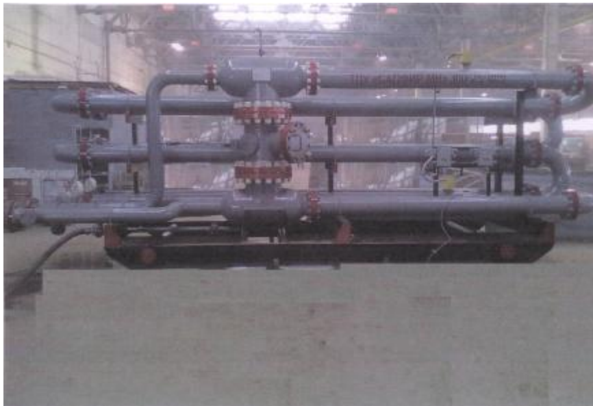
Рисунок 1 - Общий вид установки трубопоршневой «Сапфир МН»-300-2,5-0,09
