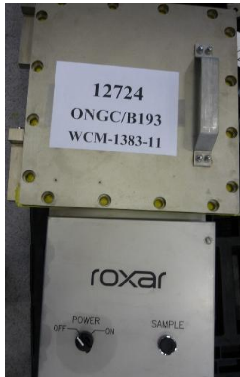
Рисунок 2 – Общий вид влагомера RFM WCM модели FC и электронного блока
