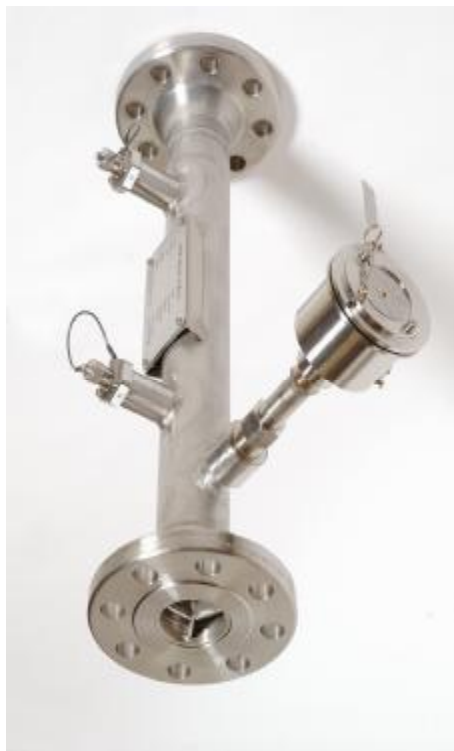
Рисунок 2 – Общий вид влагомера RFM WCM модели FC и электронного блока
