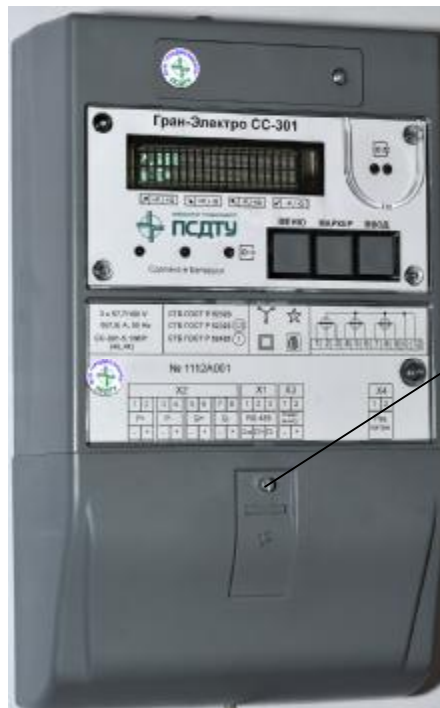
Рисунок 2 – Внешний вид счетчиков электрической энергии модификации «Гран-Электро СС-301-Х.ХХХХ» и место пломбирования энергоснабжающей организации
