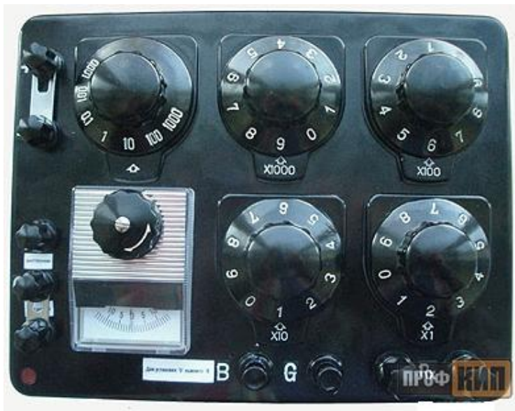
Рисунок 1 – Общий вид моста измерительного ПрофКип Р333-М1
